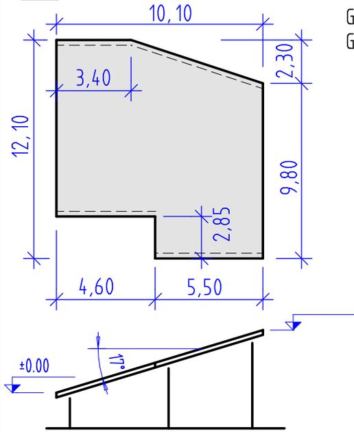
Geg.: Pulldach mit einer Dachneigungen von  $17^\circ$ .
