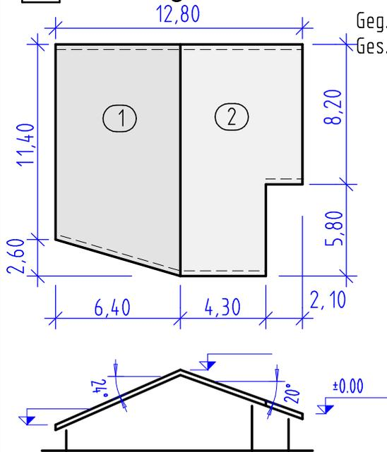
Geg.: Satteldach mit unterschiedlichen Dachneigungen ( $24^\circ$  und  $20^\circ$ ).
