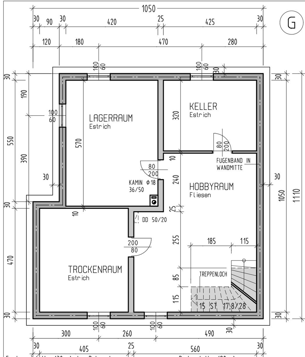
Fundamentplatte: (30cm) das Betonvolumen, die Schalungsfläche der seitlichen Abschalung, die Länge des mittig zur Außenwand liegenden Fugenbandes bei 5% Verschnitt, sowie die Mattenanzahl und das Gewicht der Grundbewehrung AQ 60 unten und oben bei 35cm Übergriff und 5% Verschnitt.
