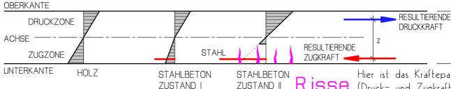
Beim Holz ist die Zugund Druckfähigkeit gleich groß. Es ergibt sich eine annähernd dreieckige Spannungsverteilung. Beim Stahlbeton übernehmen zunächst Beton und Stahl gemeinsam die Zugkräfte. = Zustand I (geringe Belastung).
