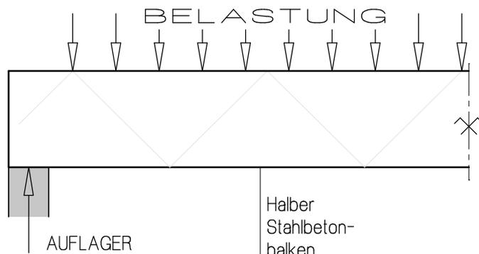
Damit die Belastung vom Feld auf die Auflager kommt, bildet sich im Bauteil eine Art Fachwerk aus. Druckstreben leiten die Last unter  $45^\circ$  nach unten. Danach muss die Last über Zugdiagonalen wieder nach oben gehoben werden. Zum Auflager hin konzentrieren sich die Kräfte. Da Beton nur beschränkt Zug aufnehmen kann, muss häufig vor den Auflagern eine zusätzliche Bewehrung (Schubbewehrung) eingebaut werden.
